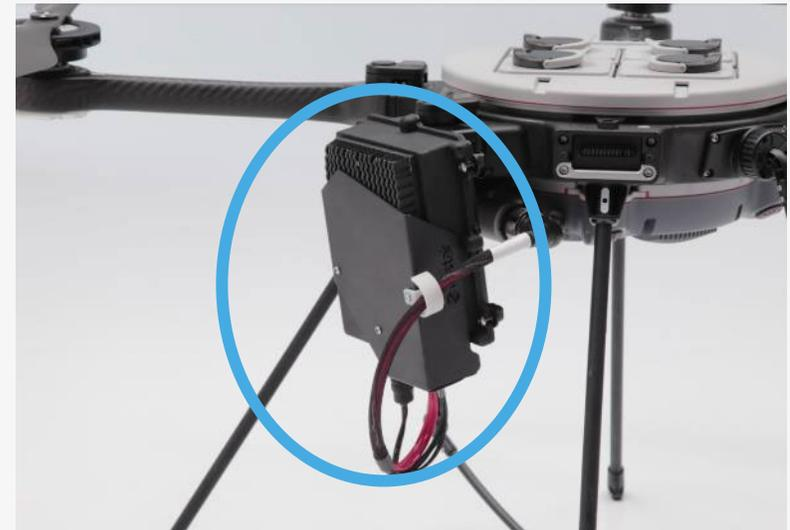
航空機モジュール。テザー経由でデータを提供、ブロック2電源/イーサネットポートに接続
