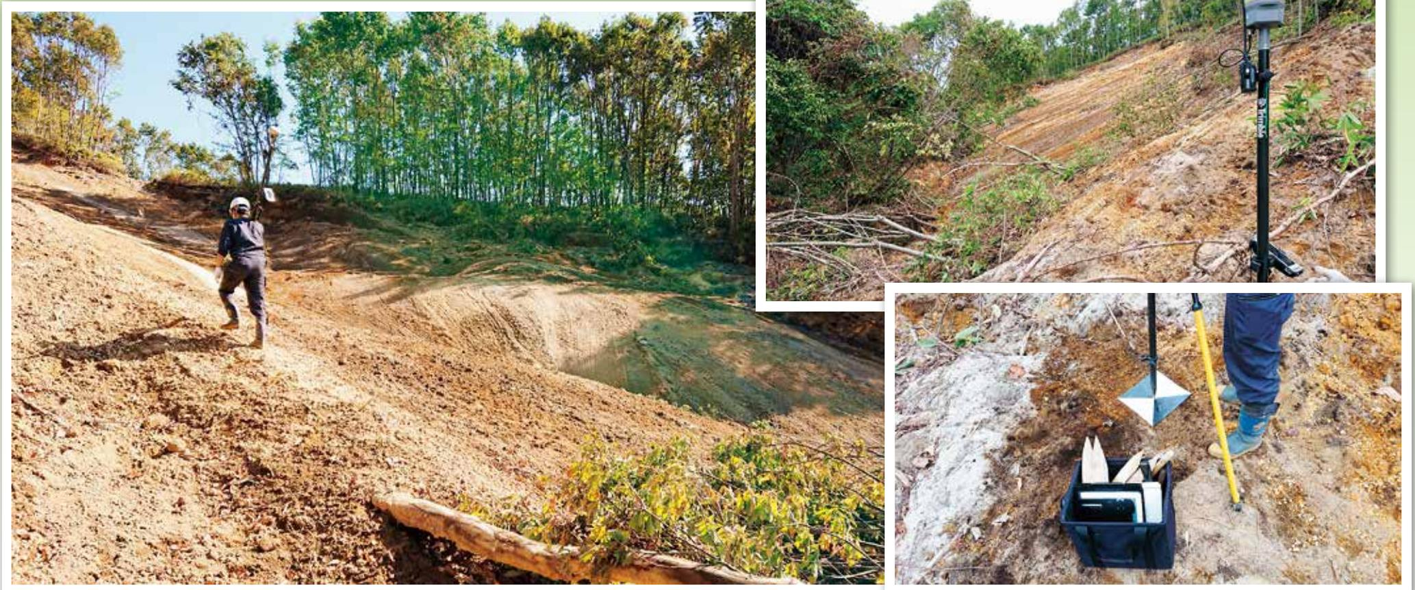
■ 農業用水路（導水路）崖崩れ現場③ 三次元データ補正用 標定点設置
