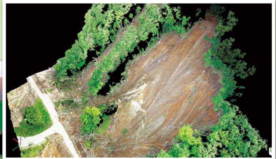
■ 農業用水路（導水路）崖崩れ現場① 空撮三次元データ解析・土砂量算出
