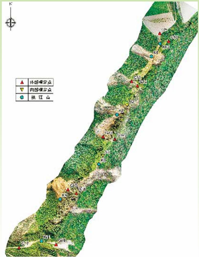
■ 農業用水路（導水路）崖崩れ現場③ 標定配点図（外部・内部・検証点）
